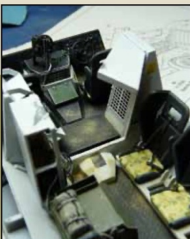
Het complete interieur. In de groene bak (het midden van de foto ▲) is de jammer ondergebracht. Het is oorspronkelijk een Australisch voertuig dus het stuur zit rechts!
